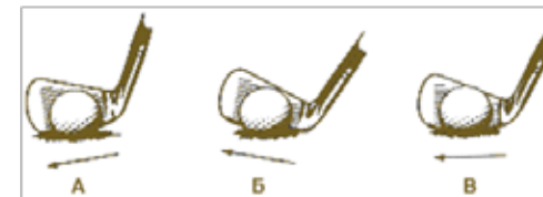
Подбор угла между рукояткой и головкой клюшки: А - если пятка оторвана от земли, лай слишком плоский; Б - если задран носок, лай слишком поднятый; В - если клюшка подобрана правильно, то лай именно такой, как нужно.
